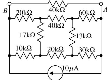
**2. a)** [22] Primenom **metode potencijala čvorova** izračunati potencijale svih čvorova u kolu sa slike, kao i struje  $I_A$ ,  $I_B$  i  $I_C$ .
